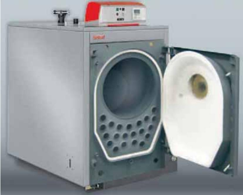
Двухходовой стальной котел с инверсией пламени в топке и специальными антиконденсационными дымогарными трубами, КПД 3 звезды согласно Директиве 92/42. «Плавающая» топка при мощностях до 680 кВт, в остальных моделях топка приварена и к задней трубной доске. Корпус котла из углеродистой стали, специальные трубы с шестисекционными завальцованными вставками (патент Unical). Котел предназначен для использования с наддувными газовыми или жидкотопливными горелками (легкое топливо)
