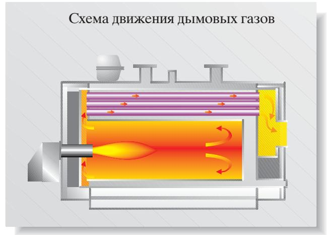
Данная система определяет охлаждение конструктивных элементов котла и уменьшает образование кальциевых отложений во внутренней его части. Овальная форма обечайки предохраняет «жизненно важные» части агрегата от наложения шлама, присутствующего в установке, и обеспечивает, таким образом, достаточный зазор между топкой и самой обечайкой.
