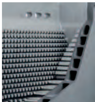
Ультракompактный, полностью охлаждаемый теплообменник-конденсатор из алюминиевого сплава (Al/Si/Mg)
